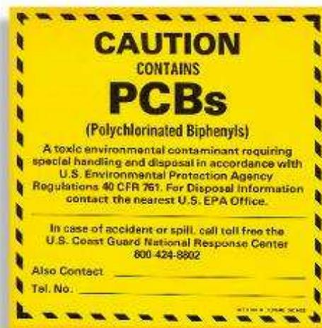
*Etichetta adesiva proposta dall'US EPA, per l'identificazione delle apparecchiature contenenti PCB*
